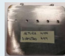
Figura 6 - Molde Metálico utilizado para a confeção dos cilindros das diferentes resinas.
