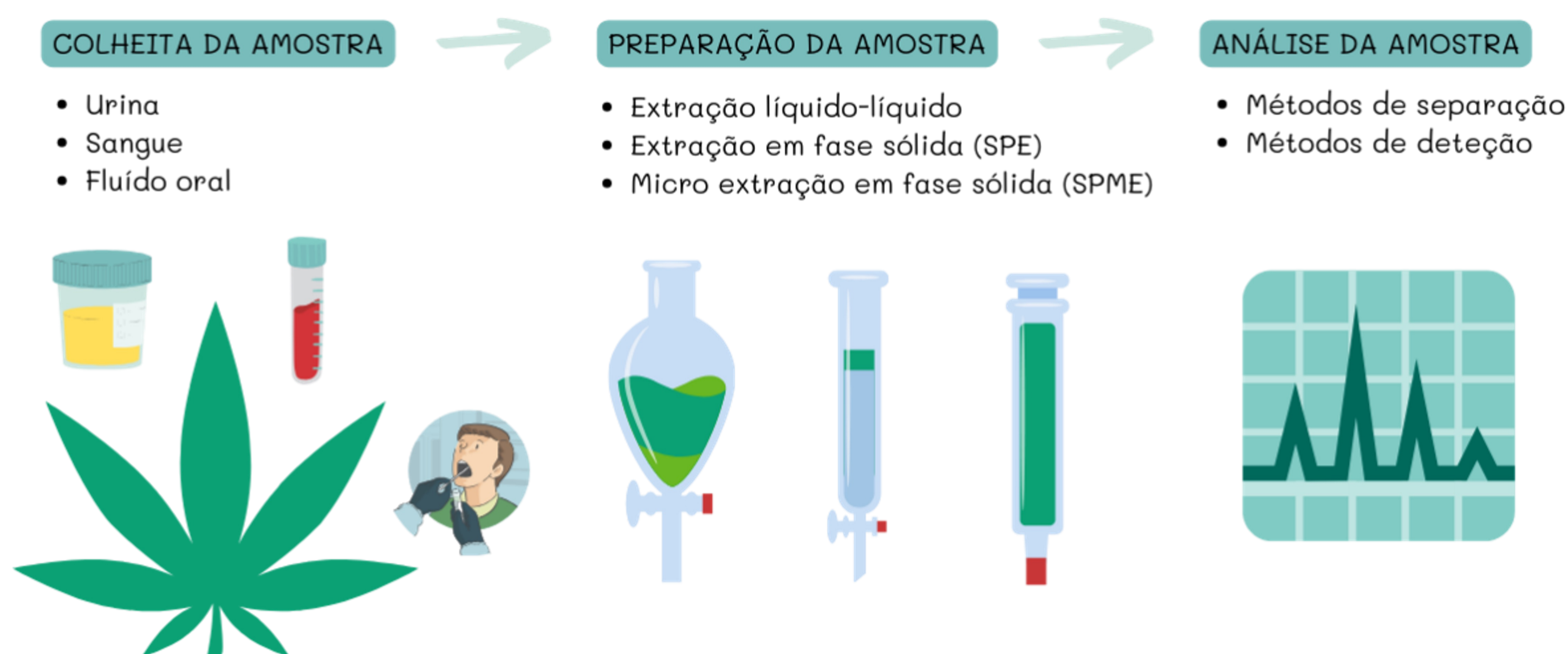
Figura 1 – Matrizes utilizadas, preparação da amostra e técnicas de análise para a quantificação de canabinóides sintéticos.
