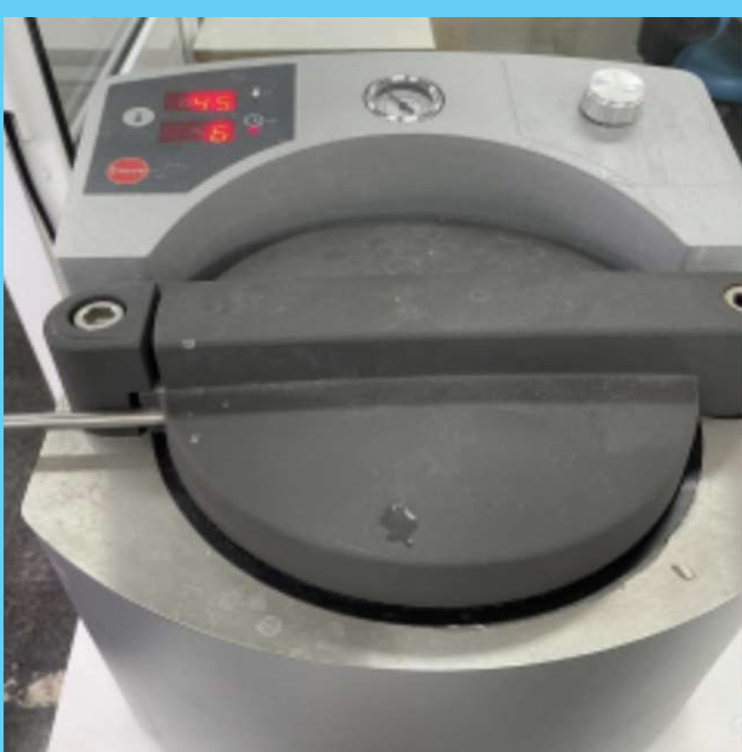
6. Colocação na prensa de pressão com água a 45°C e pressão 2 bar por 15 min;
