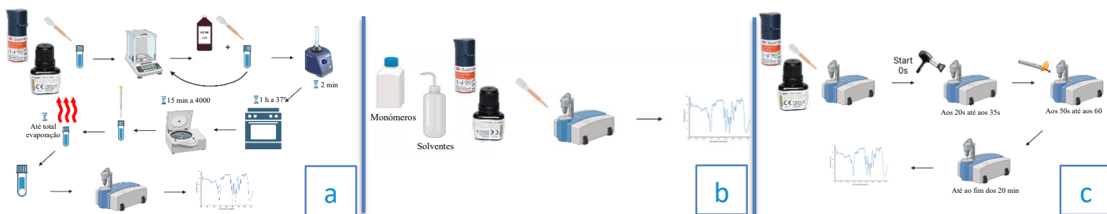
Figura 1. Protocolo ATR-FTIR: (a) Procedimento para a separação de cargas inorgânicas dos adesivos dentários; (b) Análise FTIR dos monómeros, solventes e adesivos; (c) Protocolo de secagem e polimerização dos adesivos dentários.
